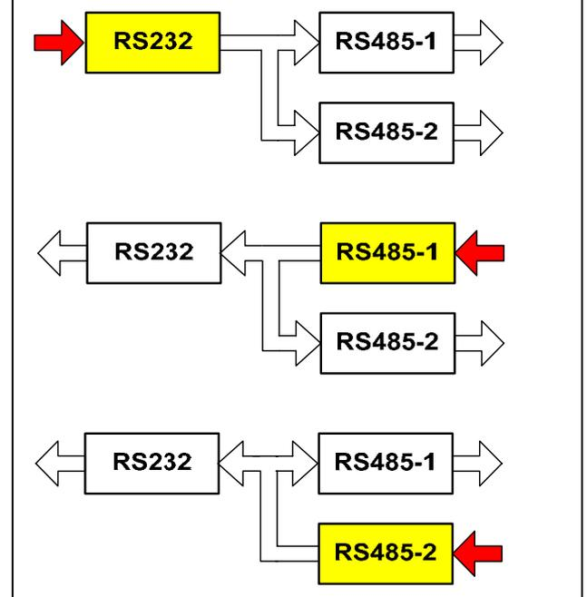
**Специальный режим** работы конвертора (Табл.2.1) предназначен для организации работы сети, к которой подключено оборудования с различными скоростями передачи данных. Данный режим позволяет работать на любой скорости, указанной в Табл.2.1, и специфицируется для конкретного оборудования (когда четко определены алгоритмы работы и протоколы связи используемого оборудования).
