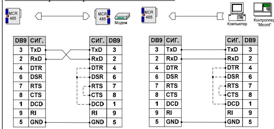
Рис. 3-1 Соответствие разъемов DB9 и DB25.
